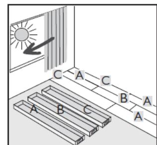
Beginnen Sie mit der Verlegung gemäß Verlegeplan in der linken Ecke der längsten Raumwand. Die Click-Verbindung an der Stirnseite und der Längsseite zu der angrenzenden Wand ist abzuschneiden. Dies gilt auch bei allen folgenden Elementen, die unmittelbar an Wände grenzen.
