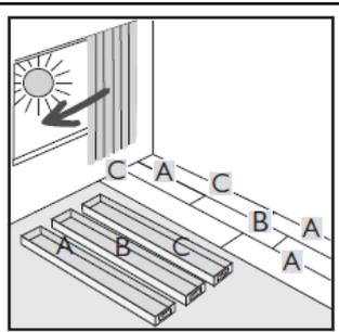
Schneiden Sie die Elemente der letzten Reihe auf Maß. Wenn das Element nicht von oben eingewinkelt werden kann, schneiden Sie die Nase der unteren Nutwanne ab, und tragen Sie etwas wasserfesten D3-Weißleim auf. Anschließend setzen Sie die Diele einfach ein. Berücksichtigen Sie hierbei auch den einzuhaltenden Randabstand.
